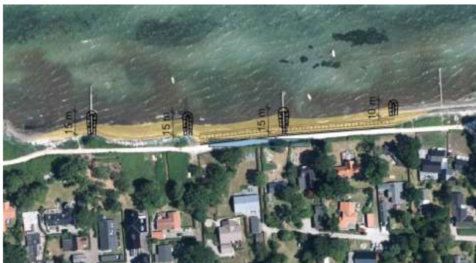
Figur 5-1 Plan over løsningsforslag med hølfer, skråningsbeskyttelse og sandfodring. Se bilag 2 (tegning C3_001).
