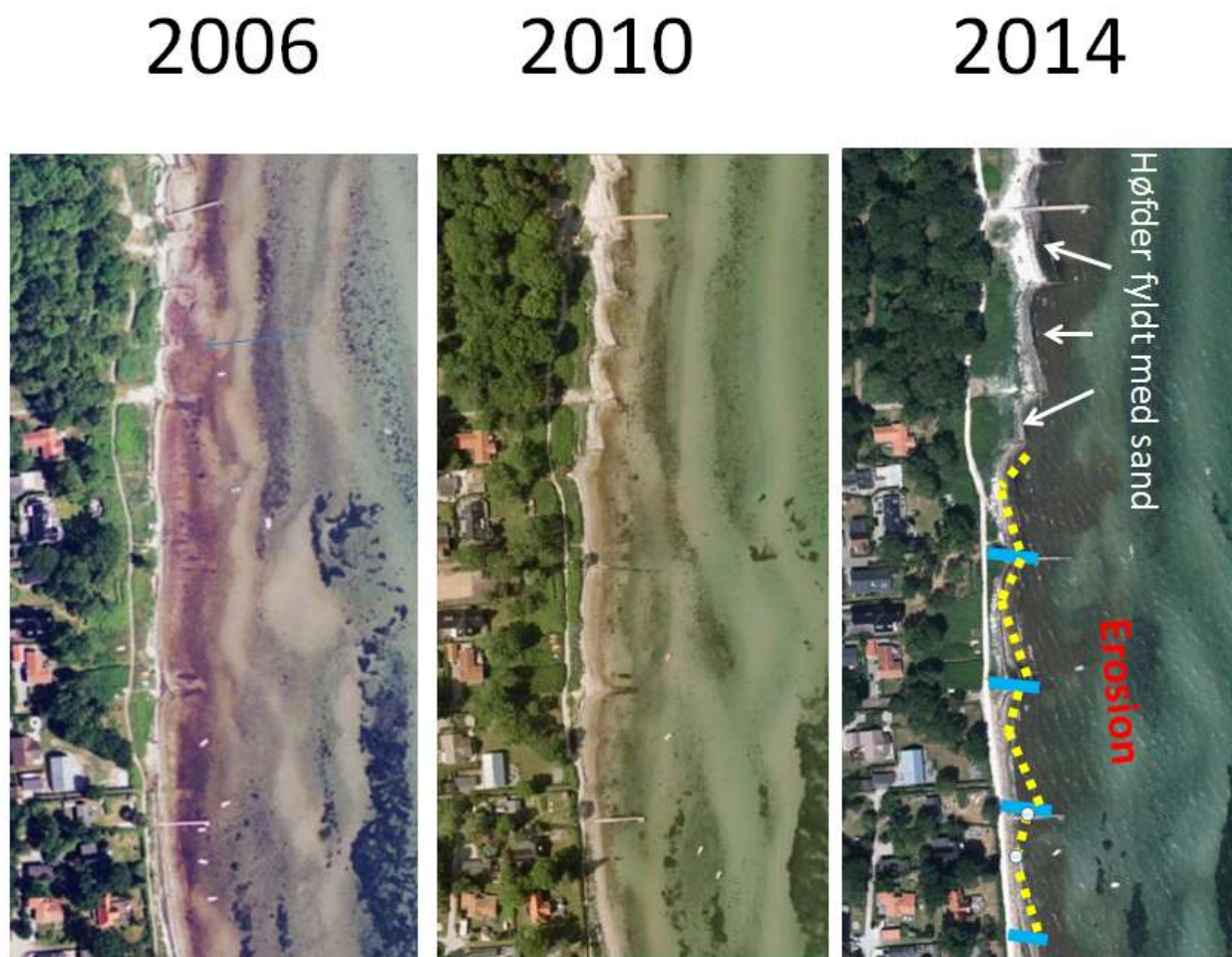
Figur 3-9 Udviklingen af hølferne opført af Hølfeholderne fra 2006 til 2014. Hølferne har samlet sand og givet anledning til laseideerosion syd for den sidste hølfe. Der kan overvejes at forlænge de sydligste korte hølfer (vist med blå farve) og supplere med to ekstra hølfer med aftagende længde mod syd. Hølferne fyldes op med groft sand (gul punkteret linje) for at reducere laseide erosionen (kilde NIRAS kort og Miljøportalen).
